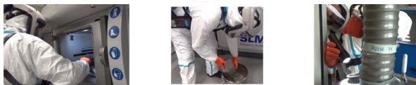
Figure 38: Situations d'exposition caractéristiques au cours des activités de travail en fabrication additive
